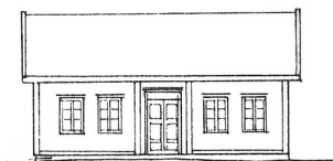
Kledd tømmerbygning 1830. (Empirevindaug.)
