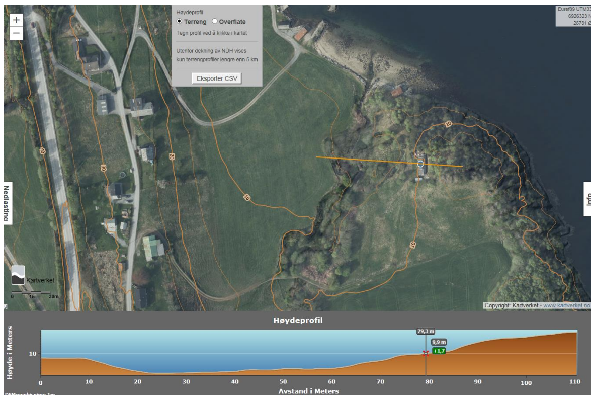
Figur 17 Hytten ligger ca. 7,5 meter over normal vannstand i Ulvestadelva, i en avstand på ca. 50 meter. Det er ingen historikk som viser flomproblemer i elva.
