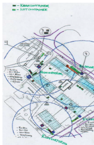
Riggplan med kranenes aksjonsradius og containerplassering in
