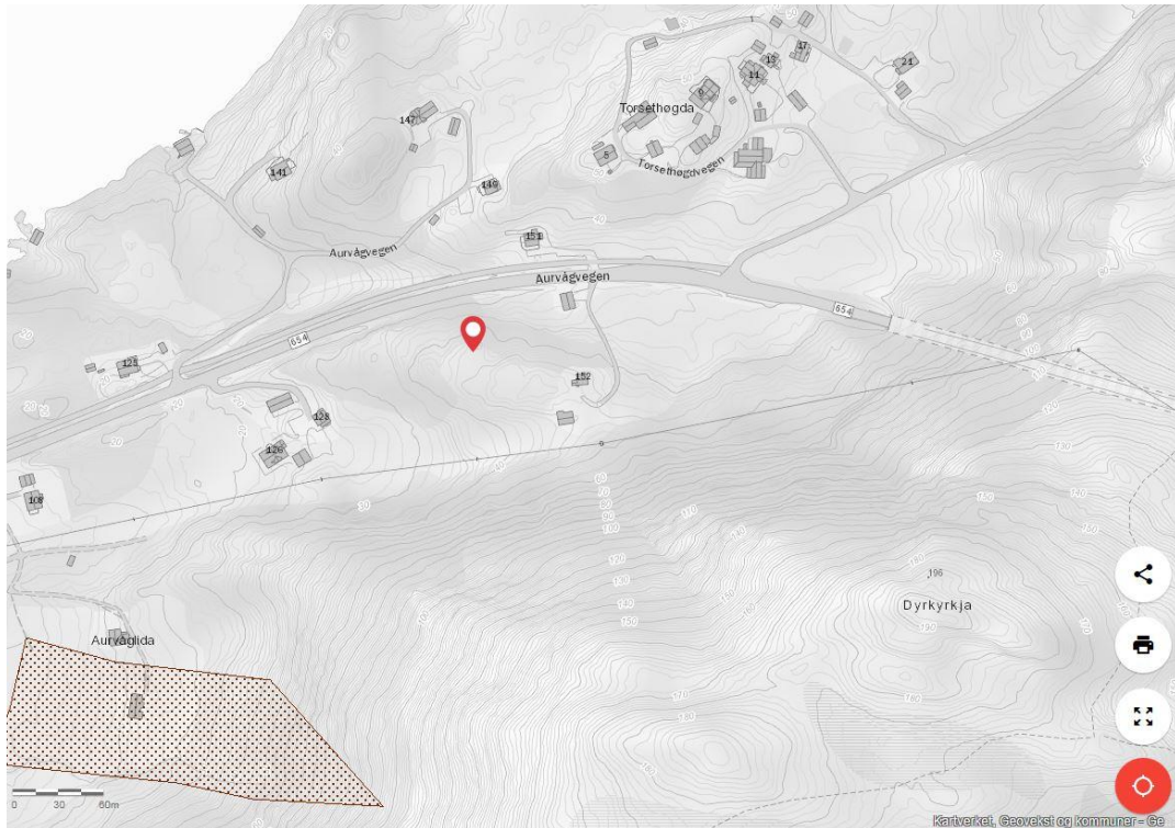
Figur 19 SkredAtlas aktsomhetskart for Jord- og flomskred viser planarealet utenfor modellert fare. Dette er verifisert i felt.
