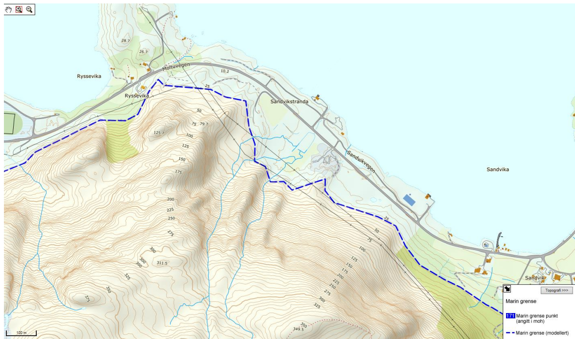
Figur 20 Planarealet ligger under marin grense og marine strandsedimenter. Ingen kjente problemer med stabilitet i marine strandavsetninger fra området.
