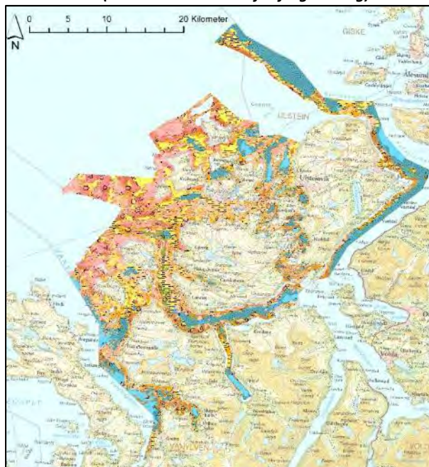
Figur 2. Arealdekkende høyoppløselige modeller (kartlag) som sammenstilles i arbeidspakke 2. Dybdemodellen (vist med terrengskygge) stammer fra Kartverket, skråningsmodellen er avledet fra denne. Modellen for lys på bunnen er laget av NIVA basert på europeiske modeller for overflatelys og lyssvekking i vannmassene. Substratskartet er utarbeidet av NGU og inneholder flater med ulike kornstørrelses-/substratklasser. Tegnforklaring for substratskart: www.ngu.no/Mareano/Kornstorrelse.html . Modellene har en oppløsning horisontal oppløsning på 2 m.
