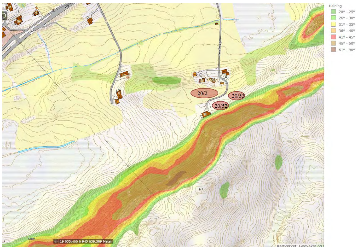
Figur 16 Fjellsiden har et relieff på rundt 100 moh. Helningsgradient på 45 - 60° i øvre del av siden, med en relativ skarp overgang til flatt parti fra fjellfoten og til tomtene. Kartet definerer ingen klare akkumuleringsområder for snø i siden. Ingen skredbaner vises.
