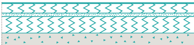
Prinsipiell oppbygging av blandingselastiske gulv
