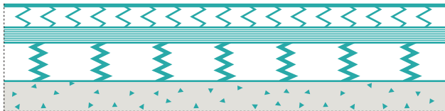
Prinsipiell oppbygging av kombielastisk gulv
