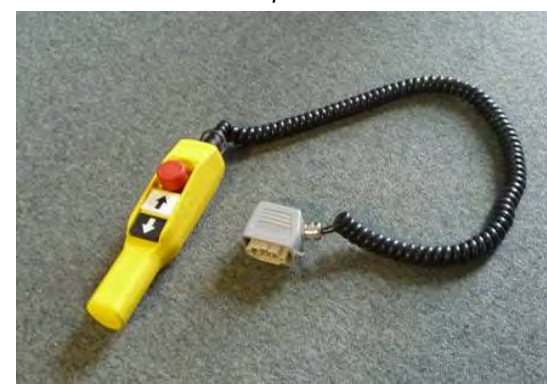
Håndkontroll med nødstop
