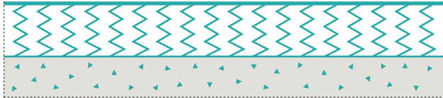
Prinsipiell oppbygging av punktelastisk gulv
